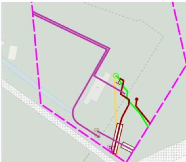
Afbeelding 2.6: Kabels en leidingen in en ter hoogte van het plangebied. (Bron: mijn.kadaster.nl)
