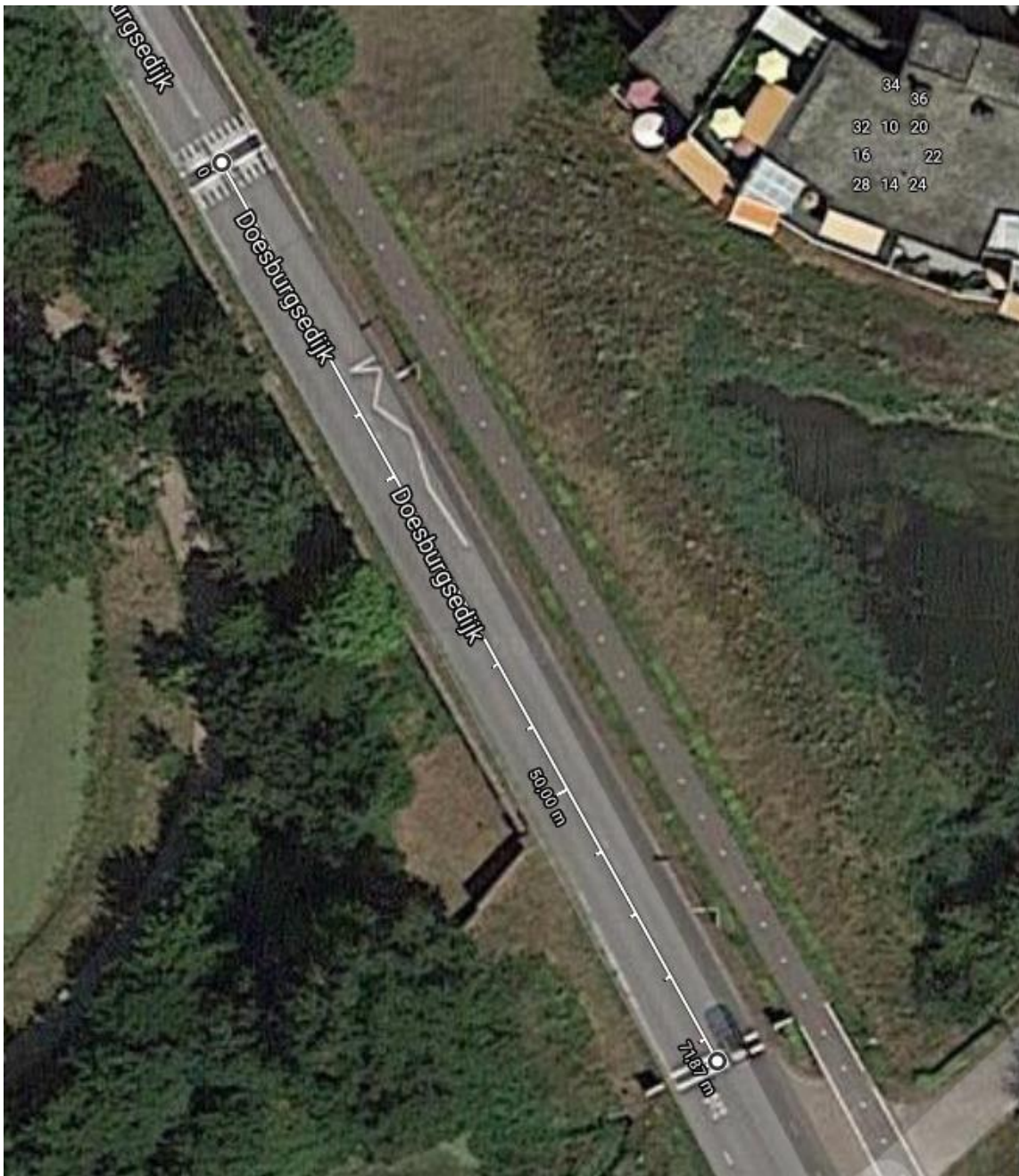
Figuur 5: Locatie van de al aanwezige snelheidsremmer, en de afstand hiervan ten opzichte van de beoogde locatie voor een extra snelheidsremmer in variant 1.
